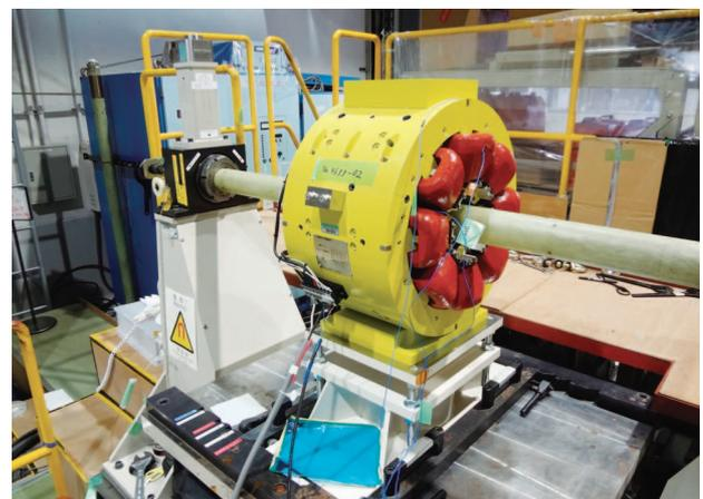
図1 ローテーティングコイルを用いた磁場測定時の写真。左がスキュー6極電磁石、右がスキュー8極電磁石である。
