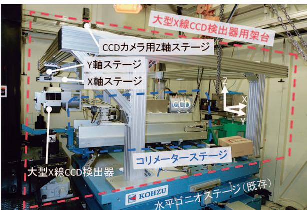
図1 SPEED-Mk. II用水平ゴニオステージ上に設置された大型X線CCD検出器の様子
