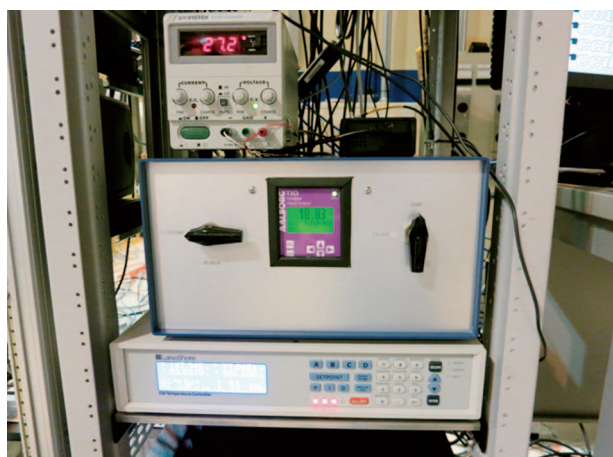
図2 N 2 /He クライオ装置コントローラー
