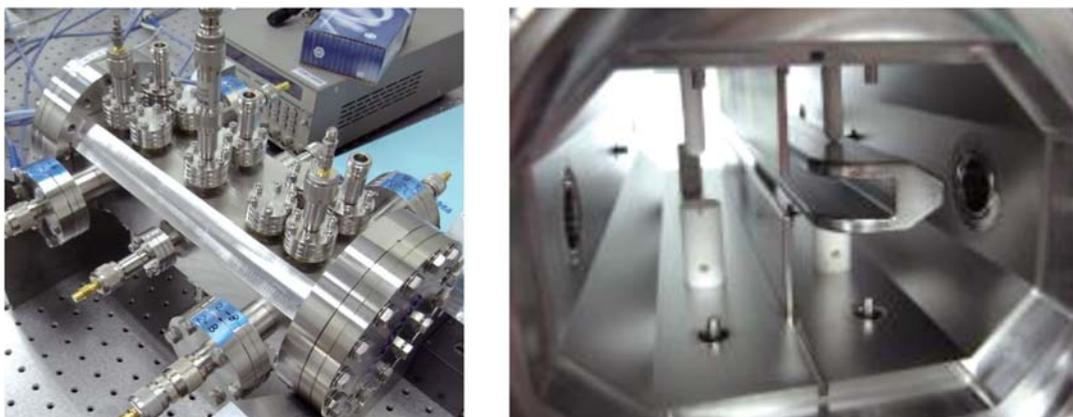
図5 高速キッカーの外観(左)と、内部構造(右、左側電極は外されている)。
