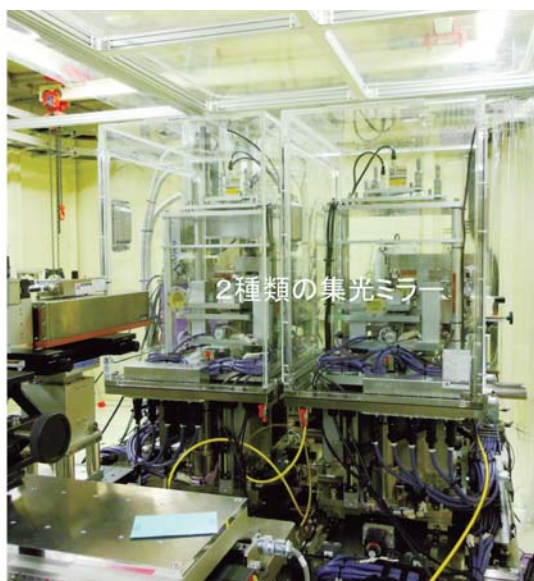
図8 BL36XU KBミラー集光装置写真
