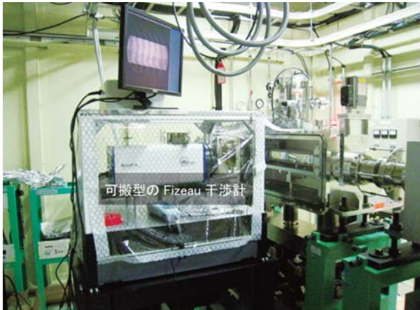
図 10 可搬型 Fizeau 干渉計を用いたベントミラーのその場形状観察
