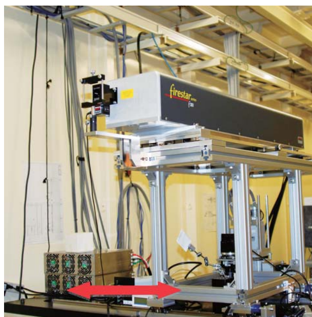
図1 BL04B2実験ハッチにインストールされた200 W CO 2 ガスレーザー
