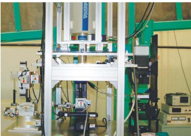
図2 90° 散乱測定用の(上)検出器、及び(下)測定装置外観。
