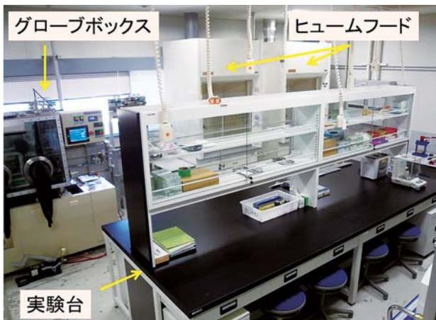
図2 BL14B2測定準備室における試料調製環境（ヒュームフード、実験台、グローブボックス）
