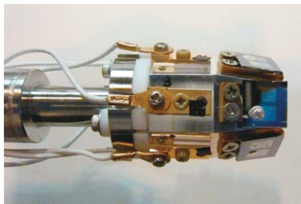
図3 バイアス印加HAXPES実験用試料ホルダー。
