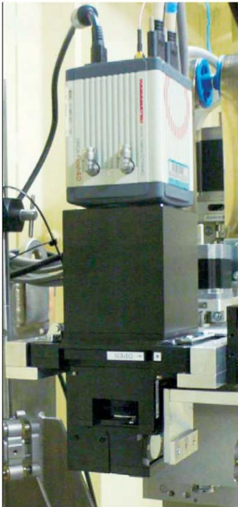
図2 画像検出器。BM2とORCA-Flash4.0の組み合わせ。蛍光体は膜厚約7  $\mu\text{m}$ の微粒子GOS。
