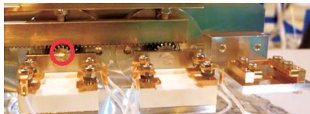
図3 電圧印加XPSサンプルホルダー受け
