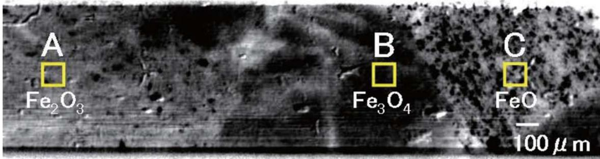
図4 観察された鉄酸化物の透過像 (X線エネルギー7140 eV)。
