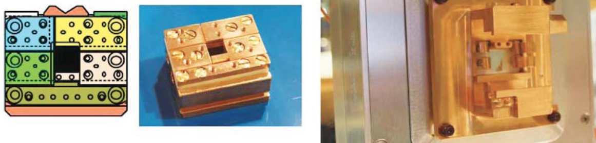
図2 3次元ナノ ESCA用バイアス印加試料ホルダー。左から試料ホルダーの模式図、作製した試料ホルダーの写真、及びバイアス印加試料ホルダー用の3次元ナノ ESCA 試料ステージの写真。
