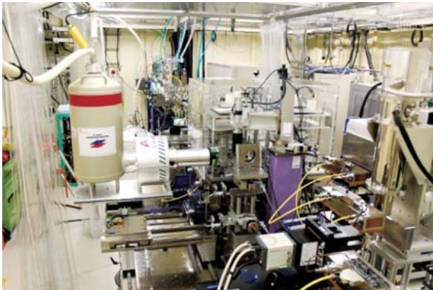
図2 実験ハッチ内 XAFS 計測システム
