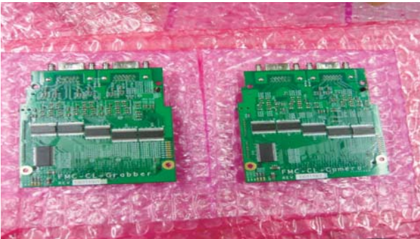
図2 新規開発したCamera Link インターフェースFMC
