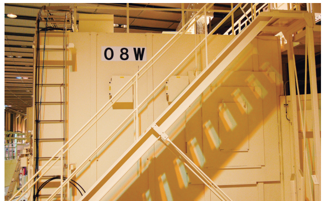
図1 BL08W実験ハッチ後壁の増設遮蔽体付近。左より実験ハッチA後方、実験ハッチB後方。実験ハッチA(B)において追加された遮蔽は光軸中心から約30 cm(25 cm)以内の範囲で鉛2.5 cm、70 cm(55 cm)以内で1.5 cm、100 cm(85 cm)以内で0.5 cmである。
