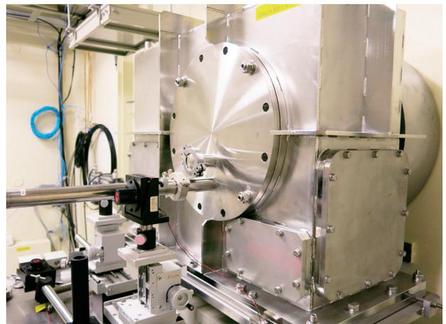
図1 空気による吸収を防ぐために導入された真空対応DSS2
