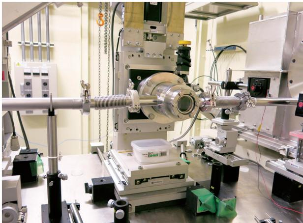
図2 HAXPES用モノクロメータのステージ・退避機構
