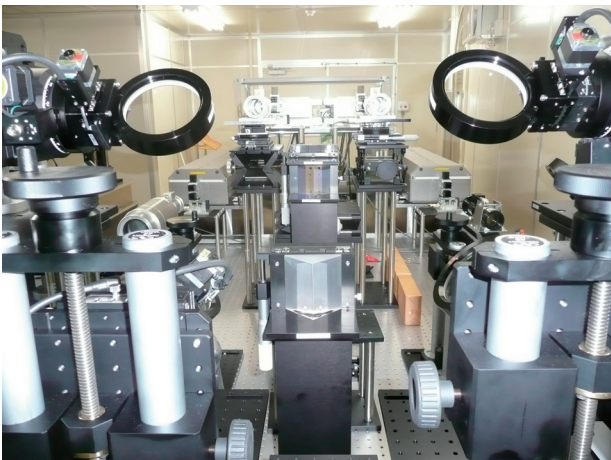
図1 BL31LEPレーザーーム内のレーザー入射システム。上下2段に各2台ずつの計4台のレーザーが設置され、エクパンダーを通過した各レーザー光は2枚のミラーで角度調整された後、上下それぞれのプリズム型ミラーで同方向に向かう。
