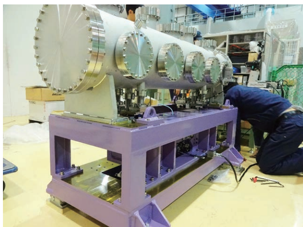
図3 軽量・コンパクト型アンジュレータ架台試験機
