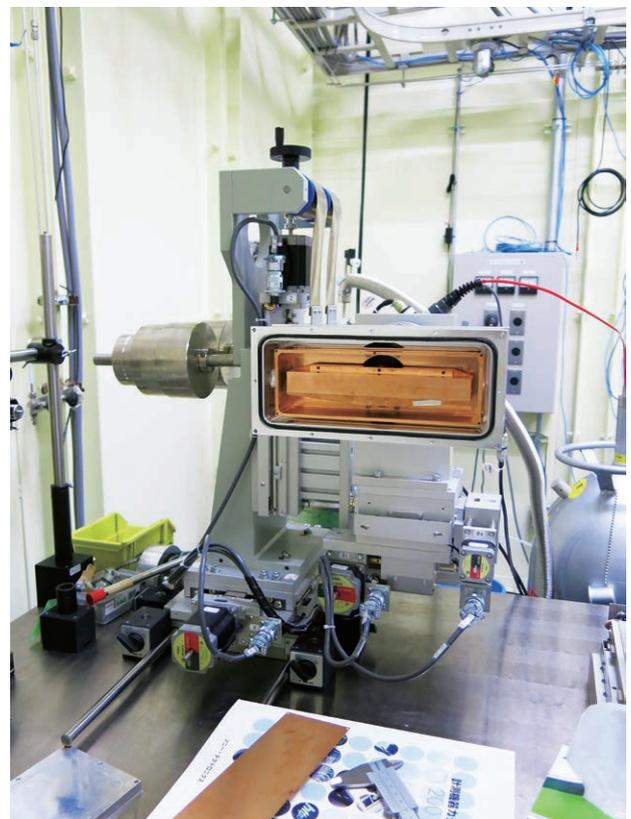
図2 厚さ20 cmまでの試料のメスbauer分光測定ができるクライオスタット
