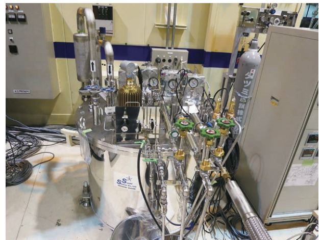
図2 (a) これまで使用した液体窒素循環装置 (b) 2014年度に新たに導入された液体窒素循環装置
