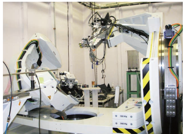
図1 BL14B1実験ハッチに導入された新規κ型回折計。表面X線回折とPDF解析に利用される。
