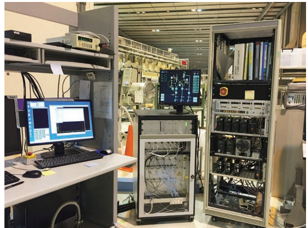
図4 Auto-XPS制御システム：左から電子分光器制御PC、電子分光器電源ユニット、インターロック制御画面、パルスモータードライバとコントローラ。
