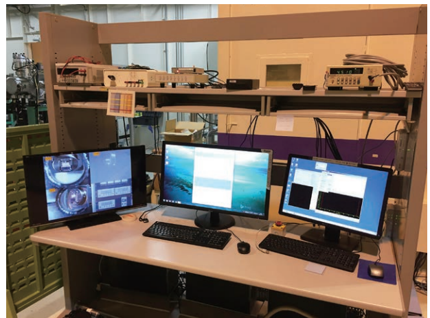
図5 Auto-XPS制御ソフトウェア画面：左からサンプル位置確認用モニタ画面、Auto-XPS制御ソフト用モニタ画面、電子分光器制御インターフェース。
