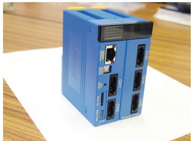
図5 開発したOPT-PLCモジュール
