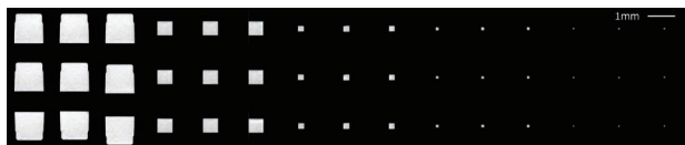
図2 コリメータ通過X線画像。左から1000 \mu\text{m} 、500 \mu\text{m} 、200 \mu\text{m} 、100 \mu\text{m} 、50 \mu\text{m} 。9素子ゲルマニウム検出器用にアセンブルしてあり、焦点は約20 \mu\text{m} 以下の精度で一致した。
