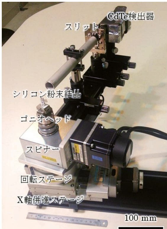
図1 白色X線スペクトル評価装置写真。
