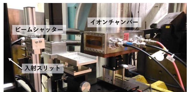
図1 単色X線用イオンチャンバーの設置状況
