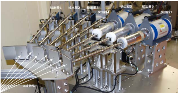
図2 BL04B2大型二軸回折計にインストールされた多連式CdTe / Ge検出器システム
