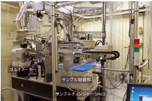
図1 高性能化後のサンプルチェンジャー SPACE
