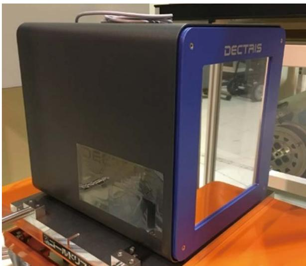
図1 更新により導入した大型2次元ピクセル検出器
