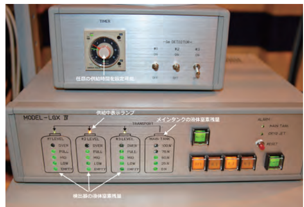
図 1 (a) BL04B2 の多連検出器装置へ組み込まれた液体窒素自動供給システムの稼働状況 (b) 液体窒素自動供給システムの制御器
