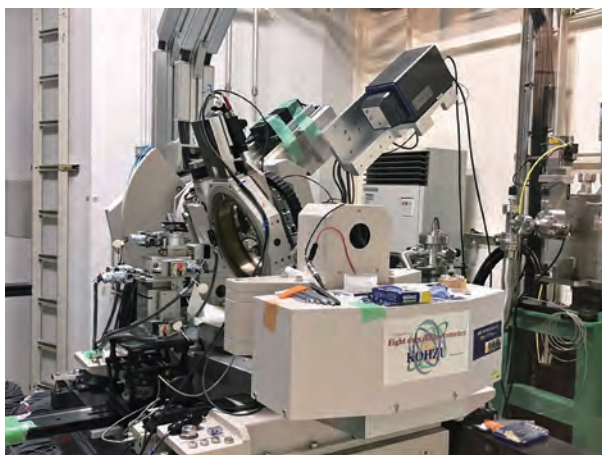
図2 PILATUSを搭載した薄膜回折計
