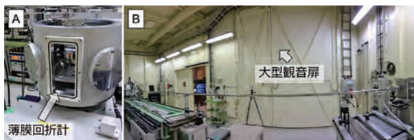
図2 薄膜回折装置;Aと第二ハッチ内部;Bの写真
