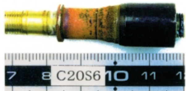
写真1 六極電磁石冷却水の流量を監視していた冷却水流量スイッチ中心軸部の損耗。左側が未使用品、右が使用品
