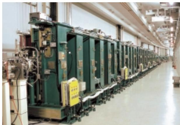
図1 SPring-8蓄積リングに設置された25 m長真空封止アンジュレータ（BL19LXU）
