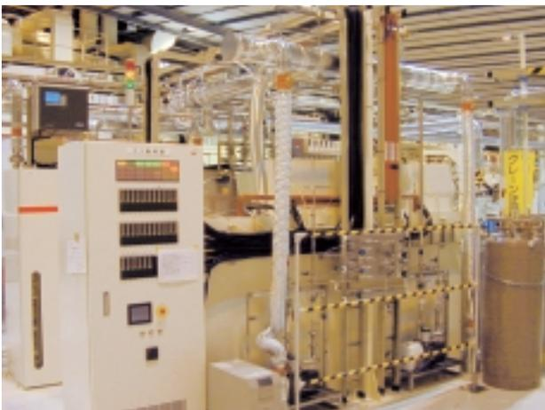
写真1 反応性試料供給処理装置
