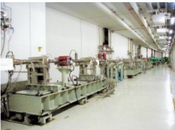
蓄積リングに4箇所配置された30m長直線部のうち、セル30を下流より見る。従来あった4極電磁石、6極電磁石は取り外し、真空チェンバとステアリング電磁石を再設置した。真空チェンバには磁気シールドを巻き、地磁気による電子ビームへの影響を抑えた。
