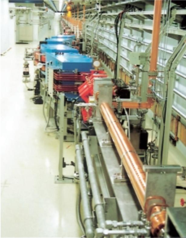
1GeV線型加速器最下流部に設置した、4台の偏向電磁石と3m長S-band加速管（手前）から構成されるエネルギー圧縮システム。このシステムによりビームエネルギーの広がりは2%から0.5%以下まで小さくなり、またその安定度は0.01%（rms）に到達した。
