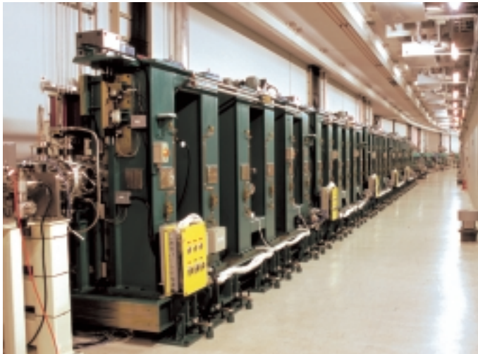
27m長真空封止アンジュレータ（内周側）。このアンジュレータはBL19LXU用光源として設置され、8 keV以上の硬X線領域で世界最高の輝度をもつ。
