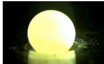
図1. 高温で浮遊する酸化物融体（東京大学 増野敦信氏提供）
