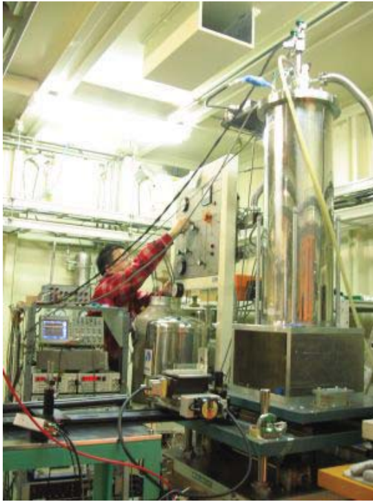
図4: 冷凍機設置の様子
