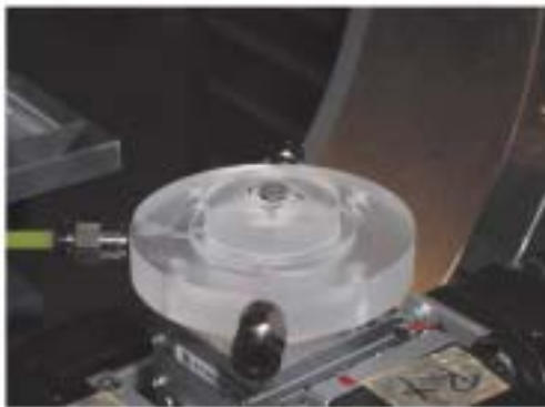
図2 多軸回折計ゴニオメータ上の試料ホルダーと試料。ホース (左、黄色) を介して、試料裏面付近の空間が真空排気されている。
