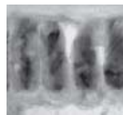
図2. ホール底部にアルミナ膜が存在する場合のコバルト柱の断面TEM観察像
