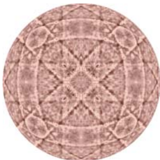
図2 鉄合金中の銅の蛍光 X 線ホログラムパターン。
