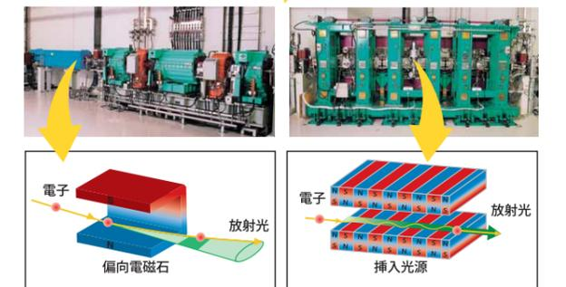
図2.蓄積リング棟内には、電子ビームを周回させる装置、偏向電磁石と挿入光源(光増強器)があり、それぞれが放射光を発生させます。
