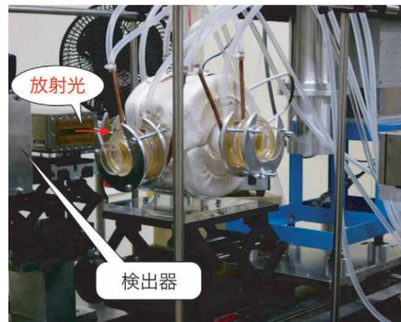
図1. SPring-8のビームラインでの実験
