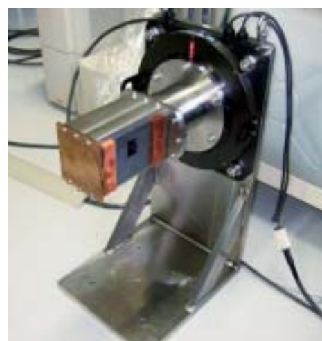
図4 コンパクト分光器の試作機
