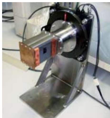
図4 コンパクト分光器の試作機
