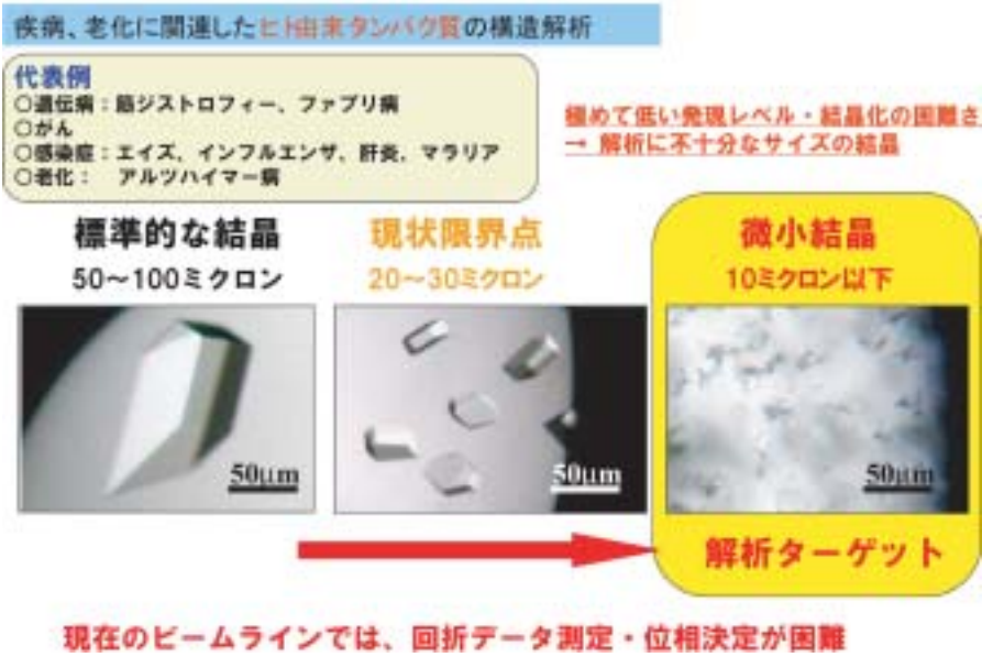
図1 本ビームラインで解析可能にするタンパク質結晶サイズ
