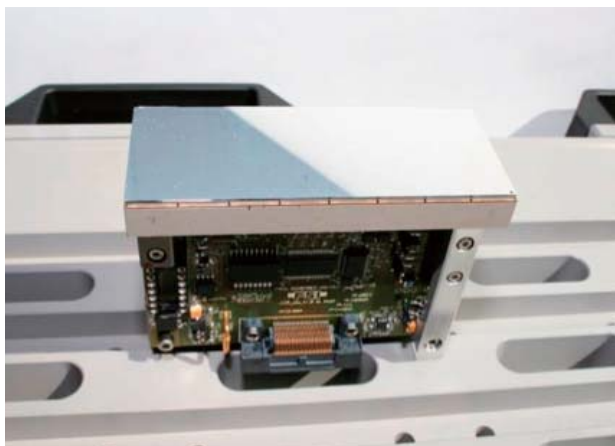
図1 PILATUSモジュール(ピクセルサイズ172 \mu\text{m} 、受光面積83.8 mm \times 33.5 mm、ピクセル数487 \times 195)
