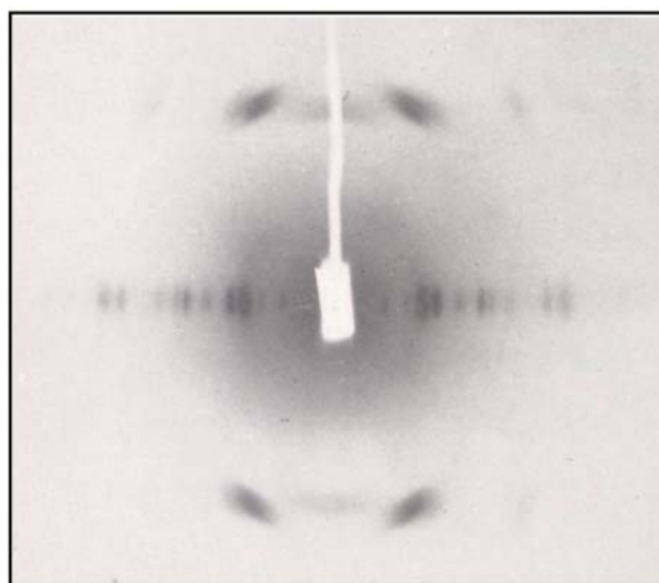
図6 1950年代に報告されたポリビニルアルコールの繊維写真(「X線結晶学」仁田勇監修、丸善(1959)より)
